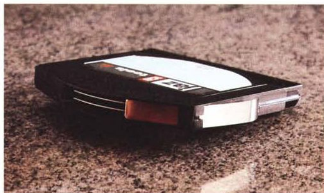
La cartuccia della capacità di 1 Gigabyte utilizzata dallo Jaz mantiene dimensioni molto ridotte, rimuovendo la finestrella anteriore è possibile vedere i due supporti che assicurano l'immagazzinamento dei dati.
